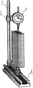
Прибор состоит из стойки 1, держателя 2, нижней опоры 3 и индикатора 4, позволяющего устанавливать изменение длины образца по сравнению с эталоном.
